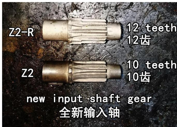
Входной вал АWAH Z2 имеет 10 зубцов, в то время как входной вал Z2-R имеет 12 зубцов
