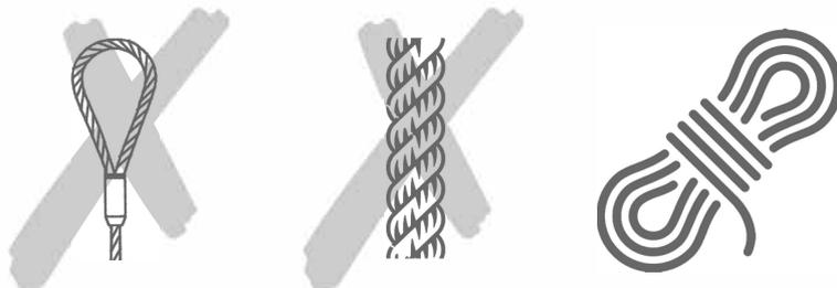
Спроектировано для альпинистской верёвки диаметром  $10.5 \leq \Phi \leq 11$  мм (обмотка + сердечник). Возможно использование троса от 9 мм до 10,5мм, однако **учтите следующее**: если верёвка окажется слишком тонкой или слишком мягкой, она может запутаться в колесе, и тогда вам придётся перерезать её. Не допускаются витые канаты или кабели.
